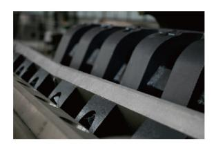
GE系列采用特殊转子设计,是一款经济型破碎 机, 其转子宽度从500mm到1400mm, 设计灵感源自 于剪刀式切割,腔体与V型转子结合,整体采用钢结构 焊接,可有效保证机器平稳运转,性能安全可靠。机身 采用紧凑型设计,便于腔体维护及刀具、筛网的更换。
